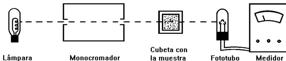
Figura 2.1: Esquema de un colorímetro
